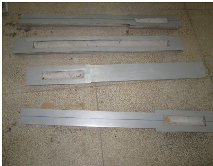
图 1 不同变径比的模型桩 Fig.1 Model piles with different values of b
